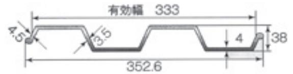
アルミ矢板 寸法および断面性能
